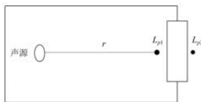
图 4-1 室内声源等效为室外声源图例
